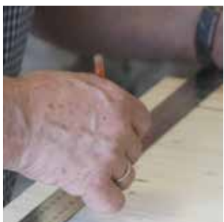
Wyznaczenie miejsca frezowania
