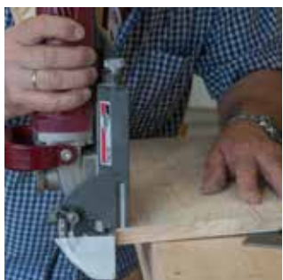
Wiercenie elementu za pomocą frezarek do wpustów (głębokość frezowania 10 mm)
