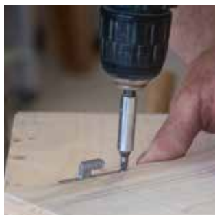
Włożenie i przykręcenie lub przyklejenie łącznika lamelkowego z zaczepem
